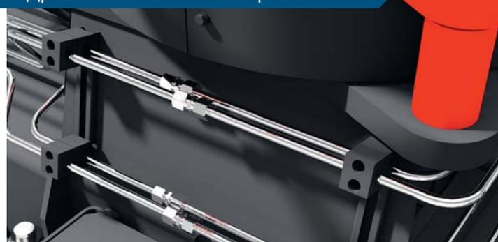
Гидравлические магистрали изготовлены с применением металлических оцинкованных труб. Применение фитингов и переходников с врезными кольцами максимально защищает от утечек в условиях пиков давления и колебаний. И обеспечивает отличную ремонтпригодность.
