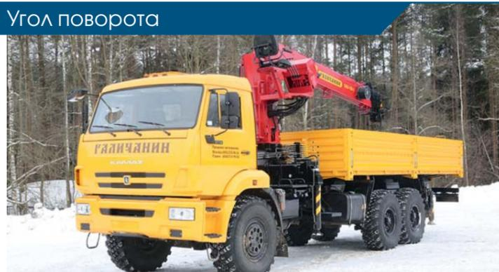
На КМУ-150 установлено опорно-поворотное устройство (ОПУ) без ограничения угла поворота, позволяющее существенно сократить время выполнения работ. Для передачи рабочей жидкости с неповоротной части на поворотную применено вращающееся соединение. Обеспечена плавность работы; нет ударов и толчков в связи с отсутствием крайних положений поворота.
