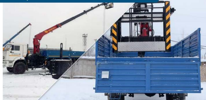
Обеспечение вылета 14 м при работе рабочей платформой (люлькой) позволяет выполнять работы среди смонтированных конструкций, без необходимости установки КМУ-150 в непосредственной близости от объекта. Данный вылет является важным параметром для многих энергетиков и служб, обслуживающих электрические сети.
