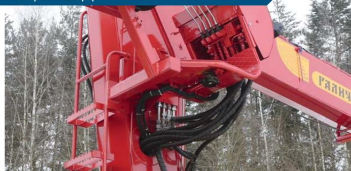
На всех рукавах высокого давления применена пластиковая защита которая предотвращает истирание и быстрый износ РВД. Она надежно предохраняет рукава даже от сильного ударного воздействия и в случае разрыва шланга защищает оператора от попадания на него масла. Кроме того, защита рукавов обеспечивает стойкость к воздействию ультрафиолетового излучения, предотвращает появление внешнего загрязнения.
