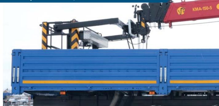
Рабочая платформа КМУ-150 имеет электроизоляцию до 400 В, что позволяет использовать ее при обслуживании электросетей. Все КМУ-150, оборудованные рабочей платформой, проходят в соответствии с Российскими стандартами испытания на пробой, что гарантирует их электроизоляционные свойства.
