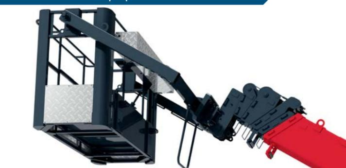
Система ориентации удерживает пол люльки в горизонтальном положении. Вывешивание на опоры может производиться без снятия рабочей платформы со стрелы, находящейся в транспортном положении. Возможность работы рабочей платформой (люлькой) без снятия крюковой подвески позволяет сэкономить время, необходимое при переводе КМУ-150 из режима работы «кран» в режим работы «подъемник».
