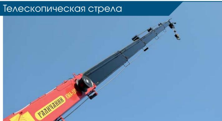
Шестисекционная стрела с максимальной длиной 19,0 м, изготовлена из высокопрочной стали. Износостойкие плиты скольжения, позволяют выполнять плавное телескопирование и не требуют обслуживания в процессе эксплуатации.
