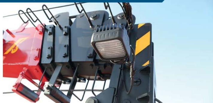
Светодиодная фара на оголовке стрелы и фара на месте оператора освещают рабочую площадку и позволяют безопасно выполнять монтажные операции в темное время суток. Фара на оголовке стрелы расположена таким образом, чтобы световой поток падал точно на крюковую подвеску, позволяя оператору видеть груз и положение подвески.
